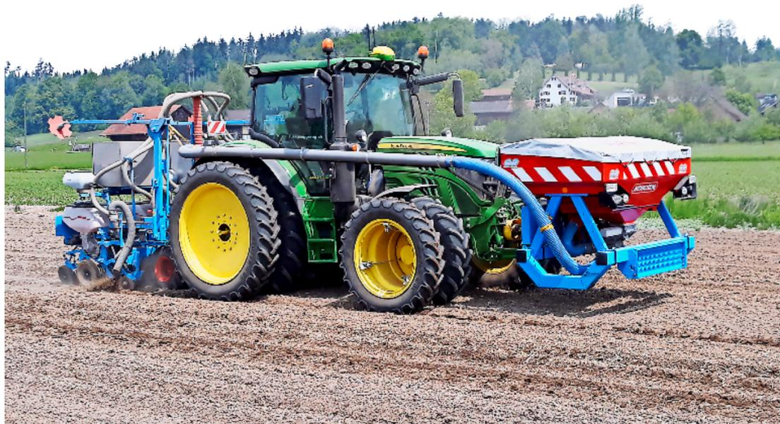
Das Lenksystem kann auch für die automatische Schaltung der einzelnen Reihen der Einzelkornsämaschine verwendet werden. Bild: Marco Landis
