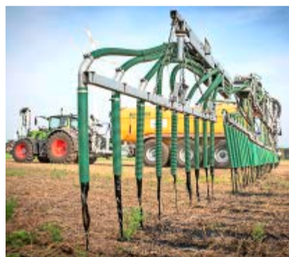
Zu Beginn wurde die Gülle-Ausbringung via Schleppschlauch überschätzt. Bild: Pixabay
