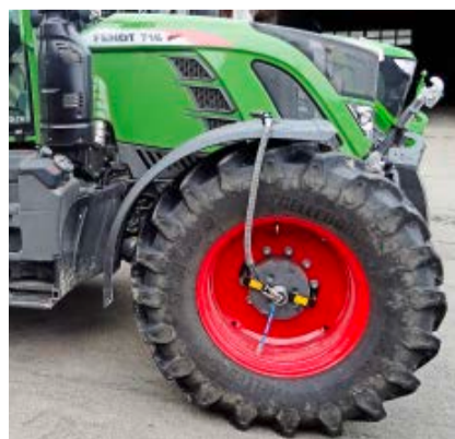
Traktor mit Reifendruckregelanlage. Bild: Daniel Häberli, Strickhof
