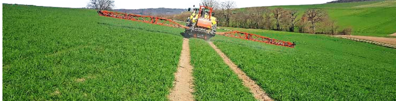
Bei Parzellen mit Fahrgassen ohne RTK-Genauigkeit, können durch Einzeldüsen-schaltung und SC Überlappungen nicht nur im Vorgewende und bei Abkehrungen, sondern auch in der Längsrichtung vermieden werden. Bild: Strickhof
