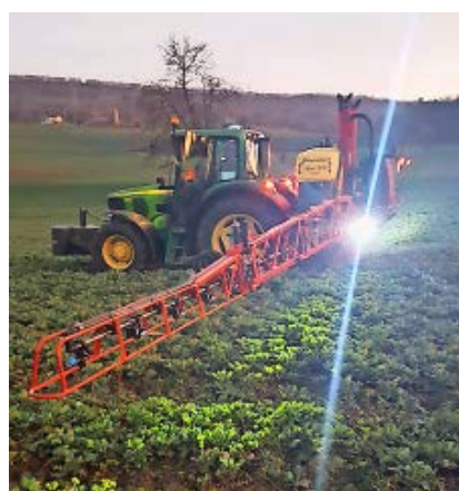
Für Section Control mit Einzeldüsen-schaltung sind RTK-Lenksysteme zu empfehlen. Bild: Strickhof
