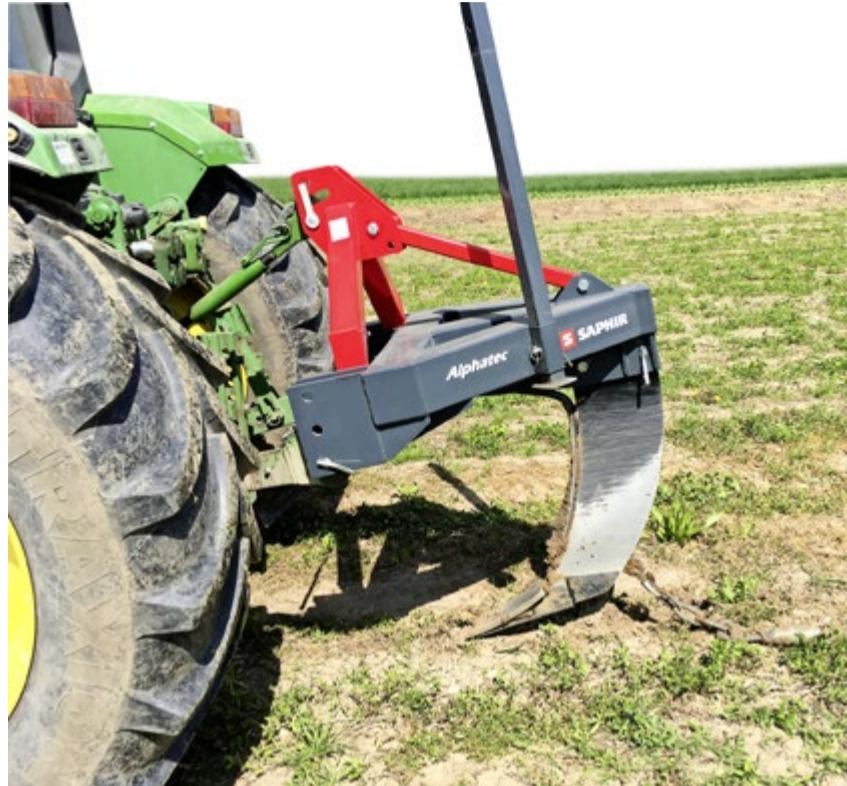
Allfällige Verdichtungen lassen sich nun punktuell gut aufbrechen. Bild: Markus Bopp
