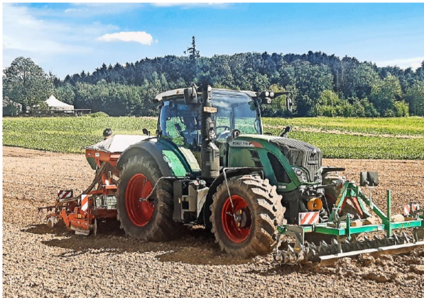
Insbesondere beim Einsatz schwerer Anbaugeräte ist ein Augenmerk auf die Achslasten zu legen. Bild: Strickhof
