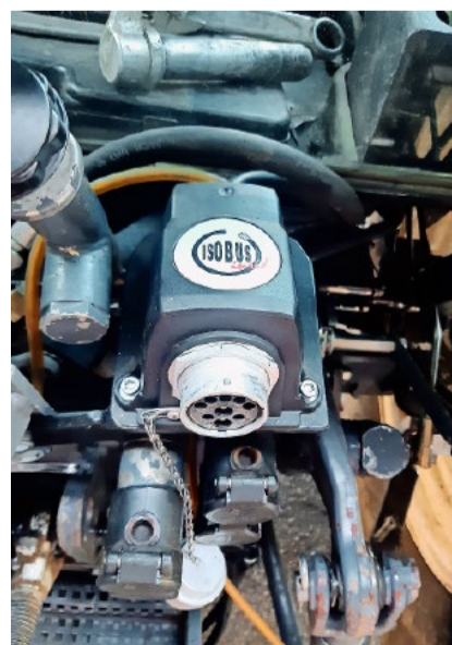
Für eine automatische Verarbeitung von Applikationskarten ist eine ISOBUS-Ausstattung von Traktor und Anbaugerät erforderlich. Bild: Strickhof
