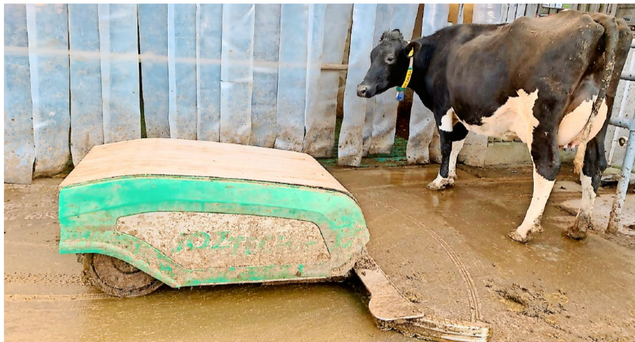
Entmistungsroboter tragen zur Ammoniakminderung bei, da sie die Laufflächen regelmässig reinigen. Bild: Strickhof
