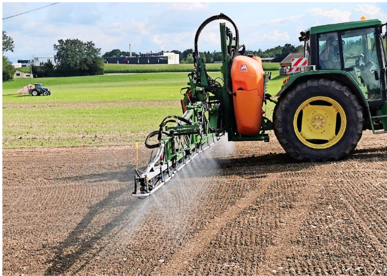
Die Drift kann effizient durch Injektordüsen reduziert werden. Dies ist bei der Abschwemmung nicht der Fall. Bild: Markus Hochstrasser
