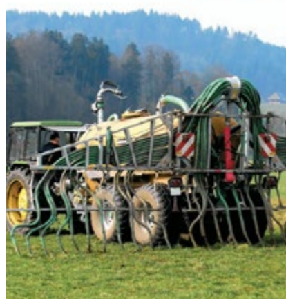
Schleppschlauchverteiler. Bild: ZBV
